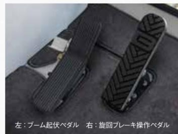
左：ブーム起伏ペダル 右：旋回ブレーキ操作ペダル
