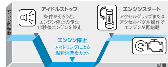
省エネと排出ガス低減に役立つ、オートアイドルストップ機能を新搭載。作業中の無駄なアイドルを防止し、燃費低減や部品消耗の抑制に貢献します。スイッチONで条件が整った場合にエンジンを停止、アクセル操作でエンジンが再始動するため、作業も妨げません。
