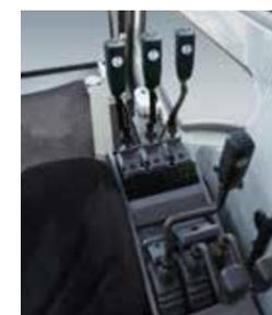
ウィンチ回転感知装置付操作レバーピッチの最適化で操作性を高めた操作レバーには、ウィンチドラムの回転感知装置も搭載。回転が手に伝わり、微妙なつり荷の動きが捉えられるため、クレーン作業によるボルト穴の位置合わせなど、繊細さを要するイン칭ング操作もスムーズです。
