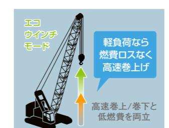
軽負荷時にエンジン低回転のまま、ハイスピードの巻上げ、巻下げを可能にするエコウインチモードを新搭載。高揚程の建設現場やロープ掛け数の多い作業などの際に、すぐれた作業効率を発揮、またエンジン回転数を抑えることで、燃費ロスや騒音も低減します。
