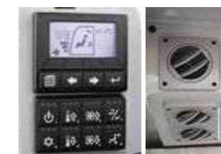
外気導入型エアコン
