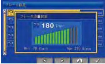
ブレーカ (ブレーカモード時)
