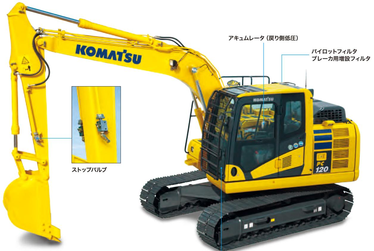
●アタッチメント流量調整機能で様々なアタッチメントにベストフィット装着アタッチメントの特性に合わせて、作動油の流量調整が運転席からワンタッチで行えます。また、ブレーカとクラッシャなどの油圧回路の切り替えも自動で行えます。
